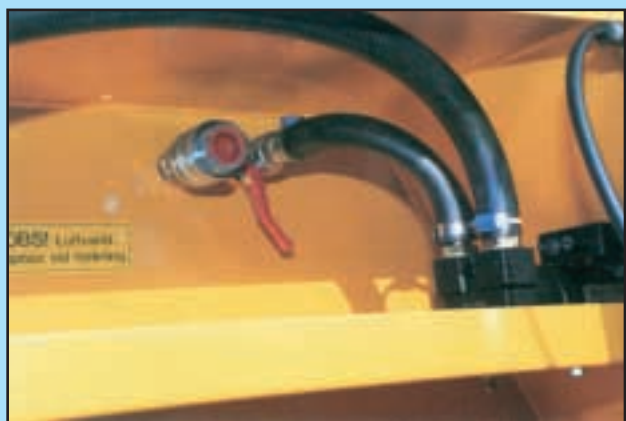
Tanking skjer via hurtigkobling eller elektrisk pumpe
